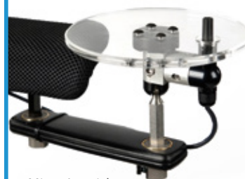
Micro Joystick zamontowany na stoliku SpaceDisk
